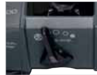
Ajuste sincronizado de convergencia y paralaje.
