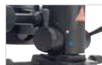
3 diaphragmes différents, filtres vert et bleu intégrés.
