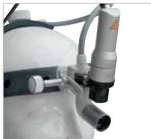
MD 1000 F.O. combinée avec optique prismatique et caméra CCD A-Cam.
