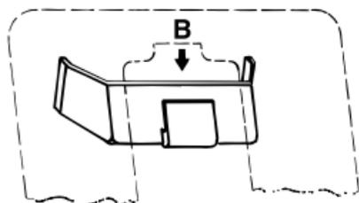
HEINE fixeringskort för dynamisk retinoskopet sätts fast på retinoskopet med hjälp av en specialhållare.
