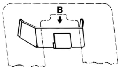
Las tarjetas de fijación HEINE para la retinoscopia dinámica se colocan sobre el retinoscopio mediante un soporte especial.
