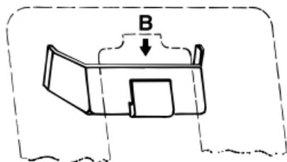
Os cartões de fixação HEINE para retinoscopia dinâmica são fixos no retinoscópio através de um suporte especial.
