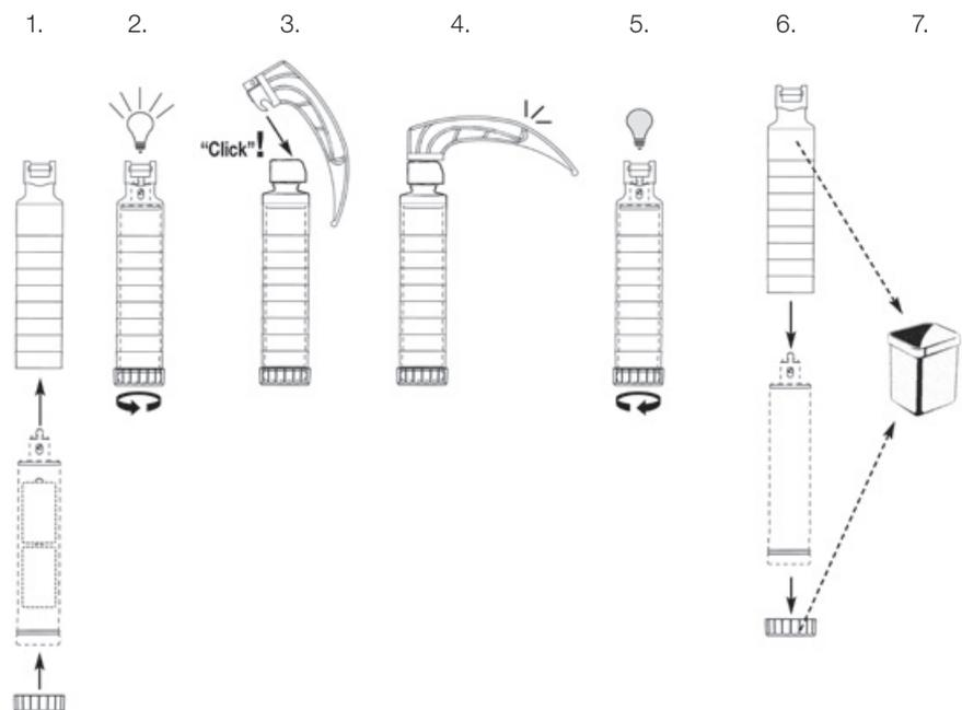
La funda del mango de laringoscopio de un solo uso XP se ha diseñado especialmente para funcionar con laringoscopios portabaterías HEINE. El laringoscopio portabaterías HEINE se coloca en la funda desechable de mango y la lámpara se enciende girando la pieza de fondo. Tras la intubación, alojando de nuevo la pieza de fondo del mango se puede extraer el laringoscopio portabaterías sin peligro de contaminación. La funda del mango, la pieza de fondo y la espátula XP se desechan.
