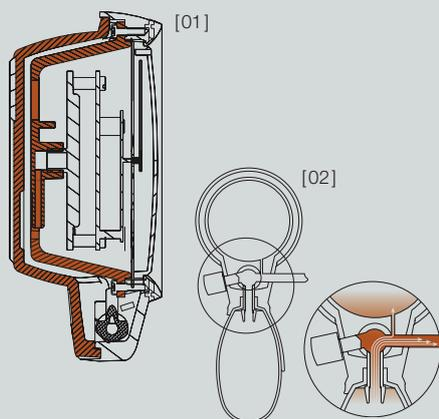
**SHOCKPROOF****[01] Construction du boîtier à double paroi, montage antichoc du manomètre.**
