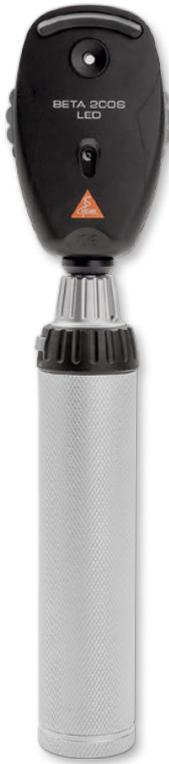
La conception unique étanche à la poussière protège l'optique de précision et permet une utilisation sans entretien. Les ophtalmoscopes BETA 200/200S sont les seuls appareils avec support en aluminium. Les composants optiques sont intégrés dans un bâti en fonte d'aluminium qui évite le décentrage et rend l'instrument résistant aux chocs. Le BETA 200S LED est équipé d'une LED d'une durée de vie pratiquement illimitée, pas de changement d'ampoule nécessaire.
