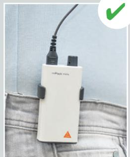
2) Vérifiez que la source d'énergie mPack mini est positionnée « tête vers le haut » dans votre poche. En positionnant la tête du mPack mini vers le bas, le connecteur ne pourra pas être débranché de la batterie. De plus, le câble pourrait se tordre ou se plier fortement provoquant ainsi, une rupture ou une usure prématurée. Pour une manipulation adéquate, nous recommandons de toujours utiliser le « Clip à ceinture mPack mini » fourni dans cette livraison.
