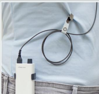
4) Veillez à ce que le câble soit toujours prêt du corps ou sous votre blous. Le clip du câble vous permettra d'attacher le câble si nécessaire. Prenez soin de maintenir le câble le plus court possible, afin d'éviter que ce dernier ne s'accroche à un élément extérieur. Utilisez simplement le porte-câble pour enrouler 2 à 3 fois le câble, comme indiqué sur la photo :
